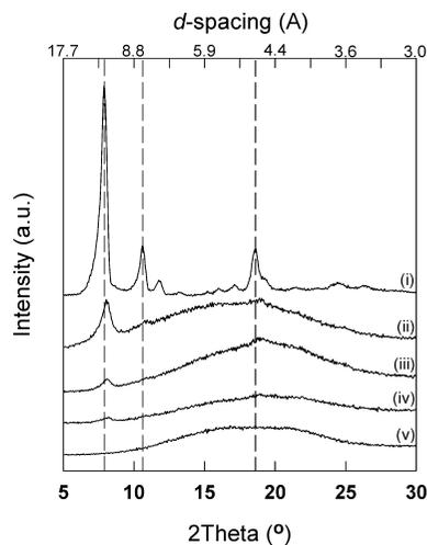
**Figure 4.** WAXD of (i) POSS diol monomer, (ii) **P(1k)LA-P3**, (iii) **P(1k)LA-P2**, (iv) **P(1k)LA-P1**, and (v) **P(1k)LA-P0**.
